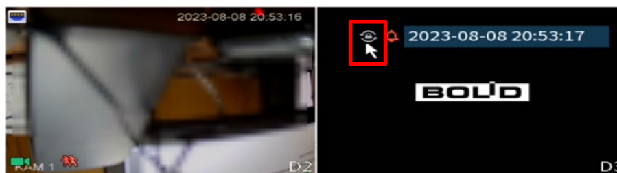
Рисунок 23.11 – Приостановка постоянного обхода
