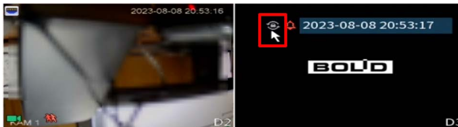
Рисунок 18.14 – Приостановка постоянного обхода
