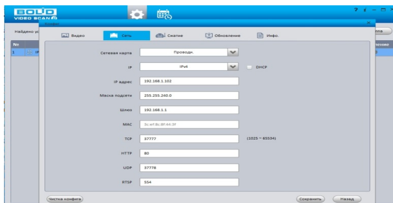
Рисунок 29.2 – Изменение IP-адреса с помощью утилиты «BOLID VideoScan»
