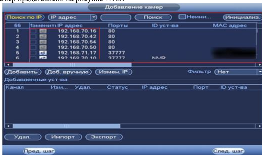
Рисунок 7.10.1 Настройка добавления камер по поиску в сети.
