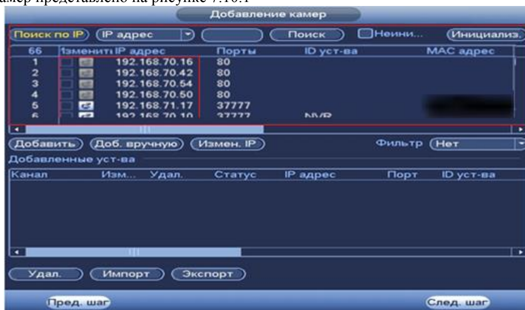
Рисунок 7.10.1 Настройка добавления камер по поиску в сети.
