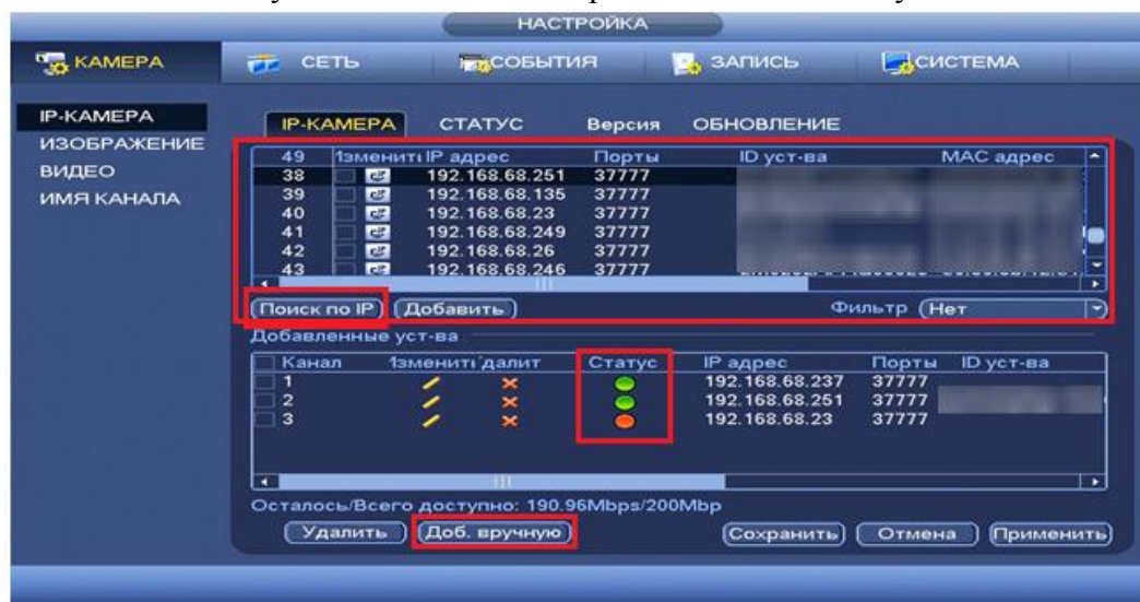
Рисунок 8.3.1.1.2 Настройка добавления камер по поиску в сети.
