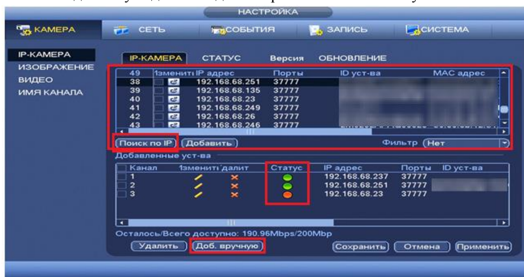
Рисунок 8.3.1.1.2 Настройка добавления камер по поиску в сети.
