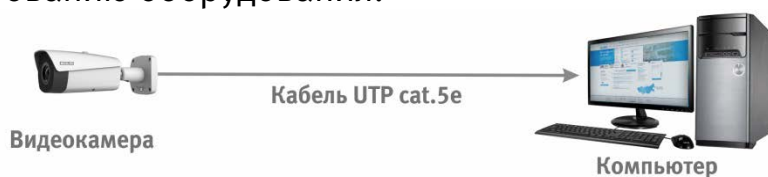
Рисунок 5.2 – Схема подключения видеокамеры к компьютеру
