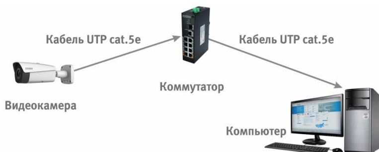
Рисунок 5.3 - Схема подключения видеокамеры к компьютеру через коммутатор
