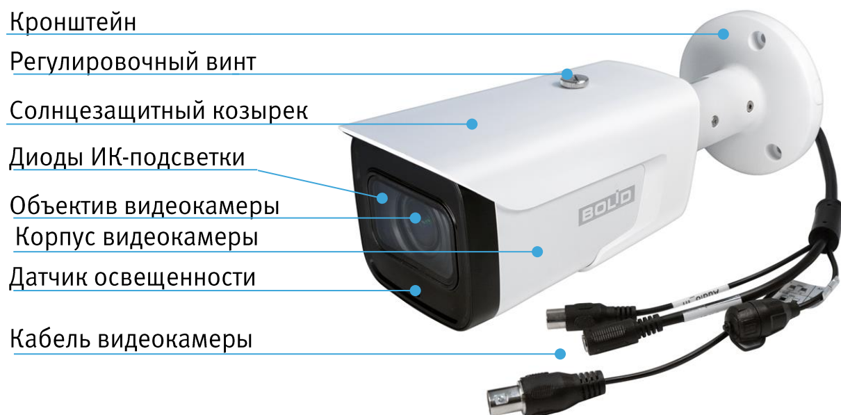
Рисунок 4.1 - Внешний вид и основные элементы видеокамеры
