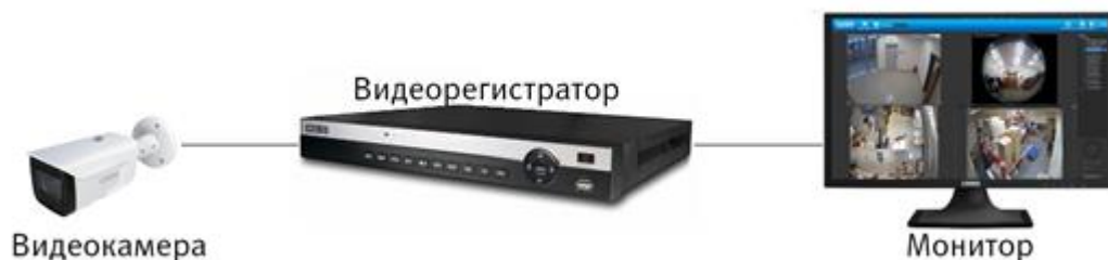
Рисунок 6.2 – Схема подключения видеокамеры
