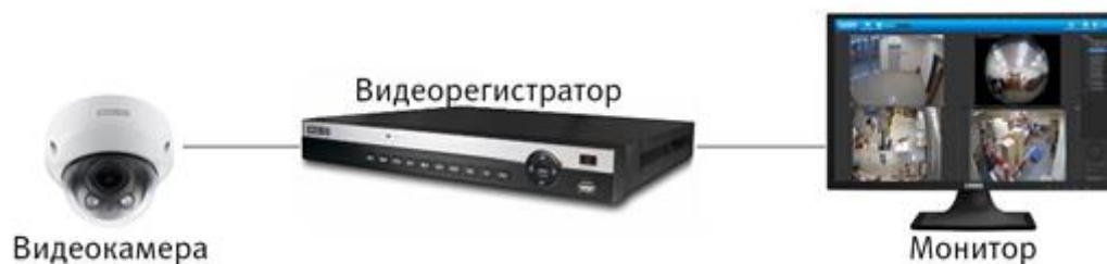
Рисунок 6.2 – Схема подключения видеокамеры
