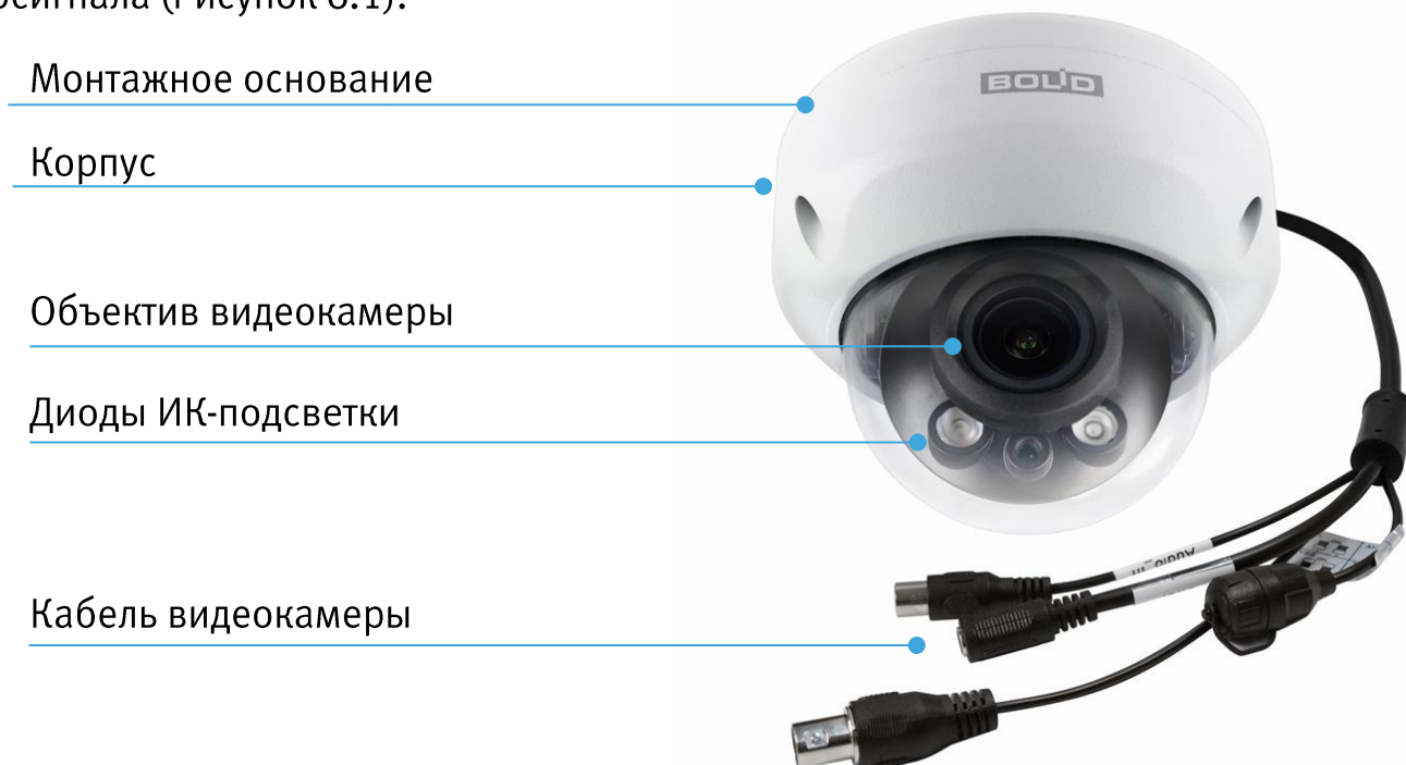
Рисунок 4.1 - Внешний вид и основные элементы видеокамеры
