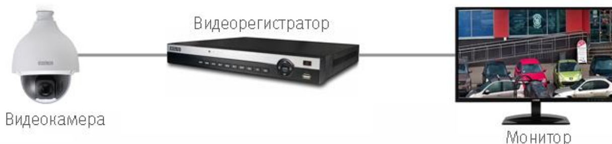
Рисунок 6.2 – Схема подключения видеокамеры
