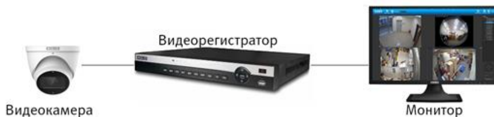
Рисунок 6.2 – Схема подключения видеокамеры
