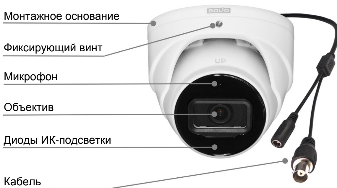
Рисунок 4.1 – Внешний вид и основные элементы видеокамеры
