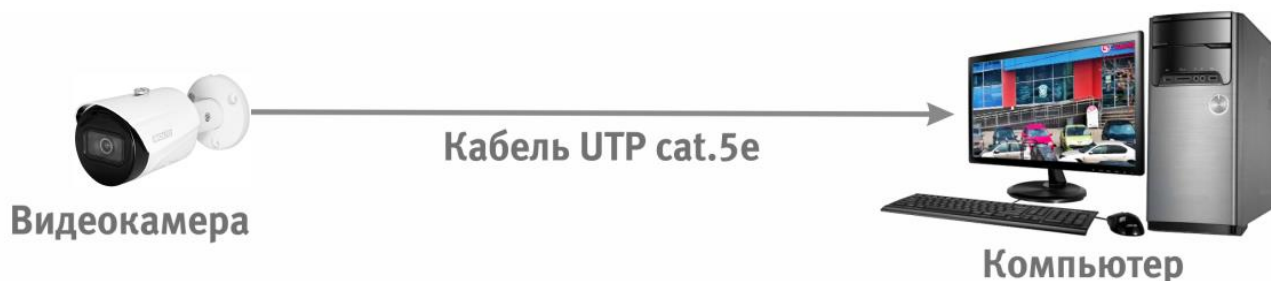
Рисунок 6.2 — Схема подключения видеокамеры к компьютеру
