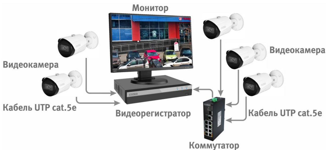
Рисунок 6.4 — Схема подключения видеокamеры к видеорегистратору
