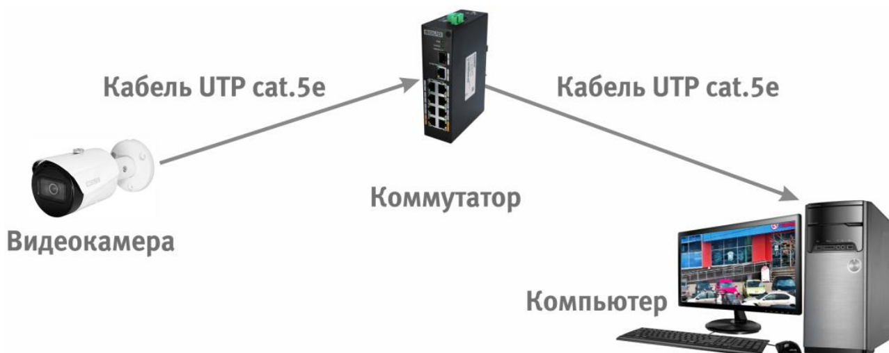
Рисунок 6.3 — Схема подключения видеокамеры к компьютеру через коммутатор
