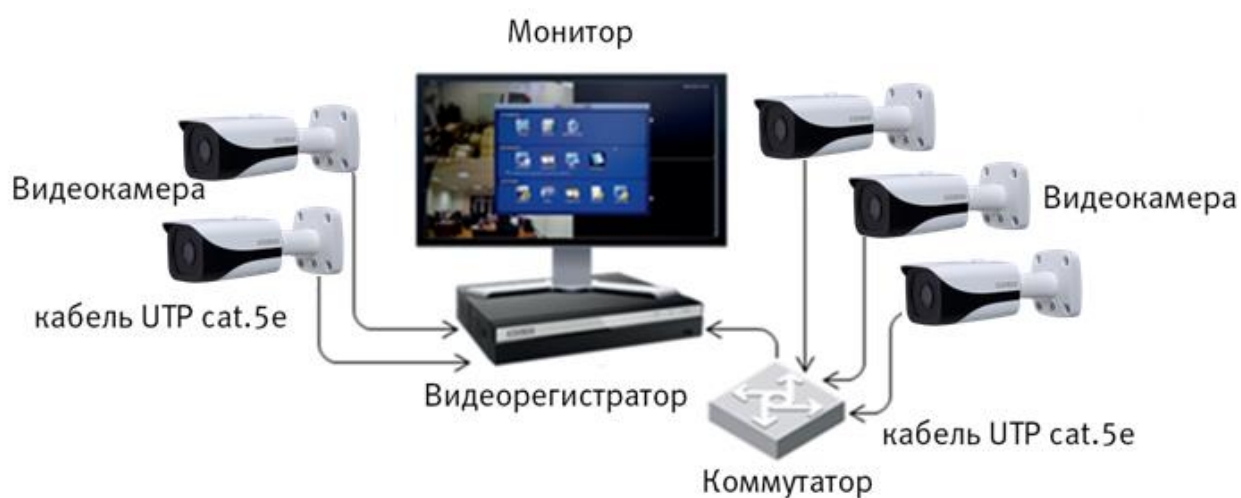
Рисунок 6.4 – Схема подключения видеокамеры к видеорегистратору
