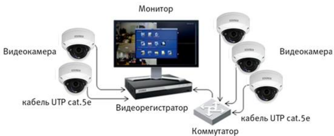
Рисунок 6.5 – Схема подключения видеокамеры к видеорегистратору
