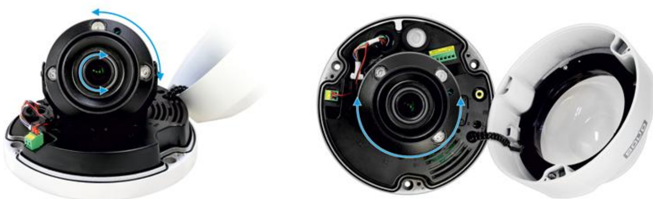
Рисунок 5.16 – Настройка направления объектива
