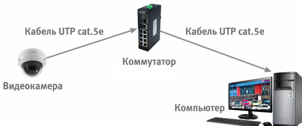
Рисунок 6.3 – Схема подключения видеокамеры к компьютеру через коммутатор
