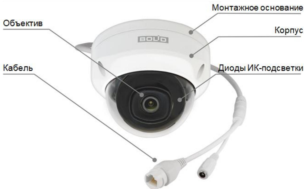
Рисунок 4.1 – Внешний вид и основные элементы видеокамеры
