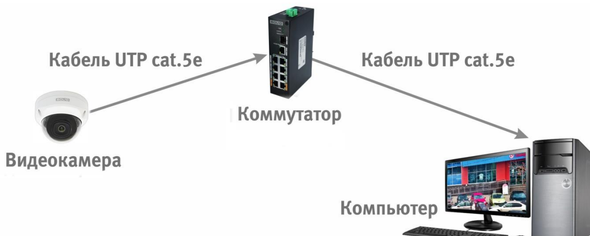
Рисунок 6.3 – Схема подключения видеокамеры к компьютеру через коммутатор
