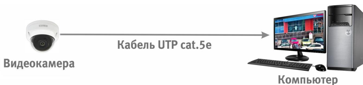
Рисунок 6.2 – Схема подключения видеокамеры к компьютеру
