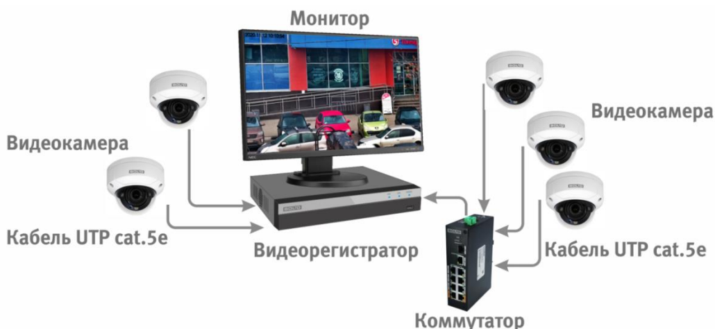
Рисунок 6.4 – Схема подключения видеокамеры к видеорегистратору
