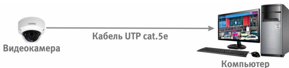
Рисунок 6.2 – Схема подключения видеокамеры к компьютеру
