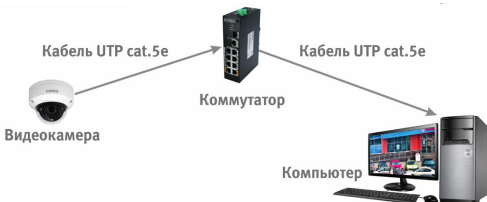
Рисунок 6.3 – Схема подключения видеокамеры к компьютеру через коммутатор
