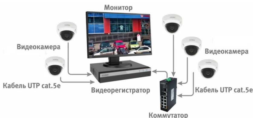
Рисунок 6.4 – Схема подключения видеокамеры к видеорегистратору
