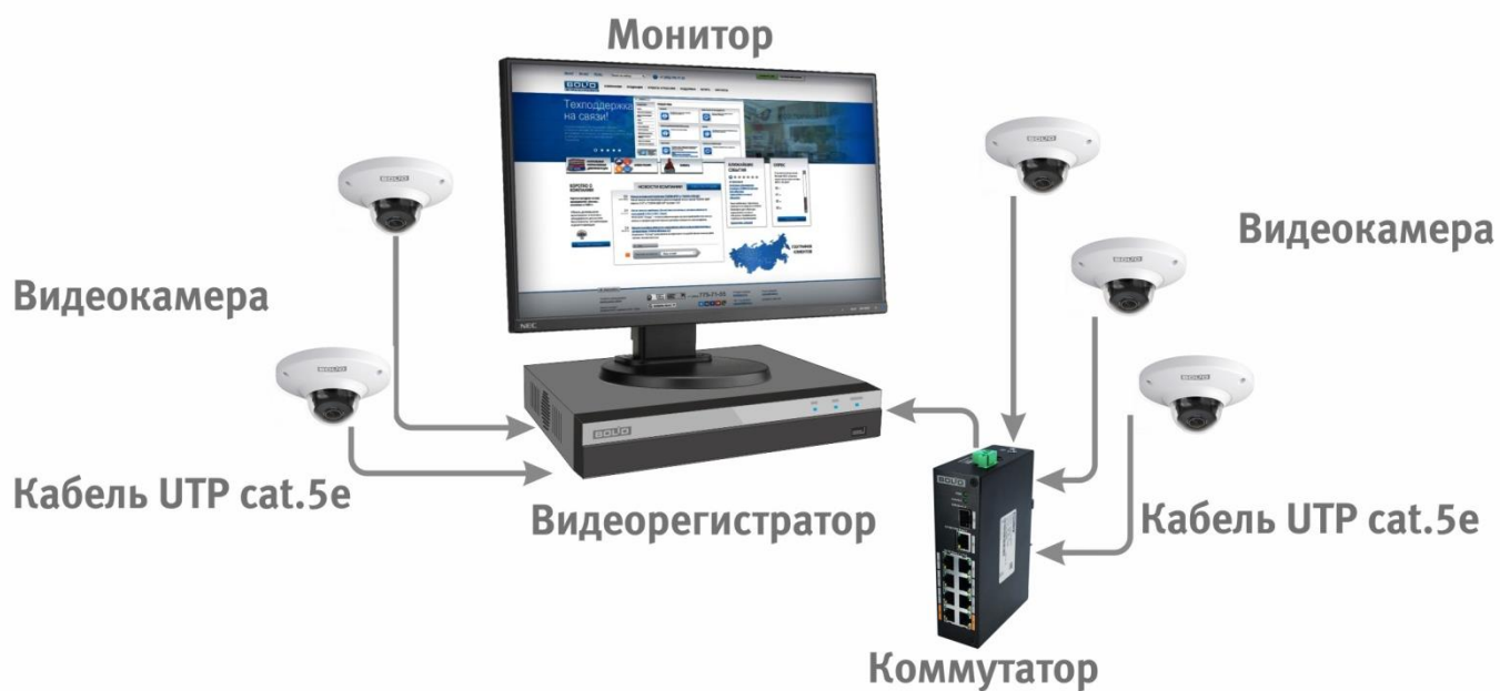
Рисунок 6.4 – Схема подключения видеокамеры к видеорегистратору
