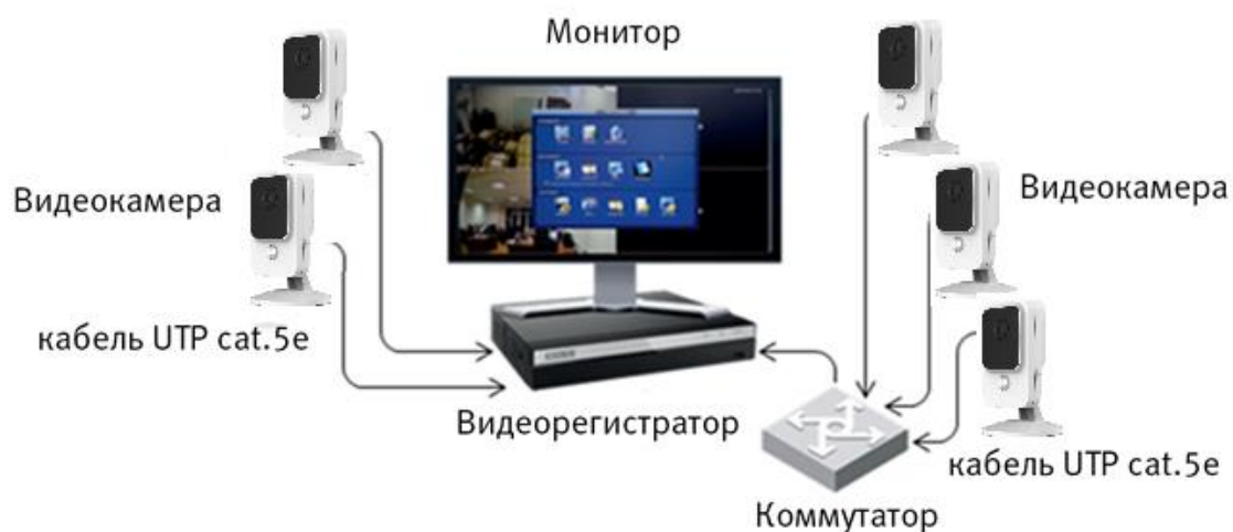
Рисунок 5.5 – Схема подключения видеокамеры к видеорегистратору
