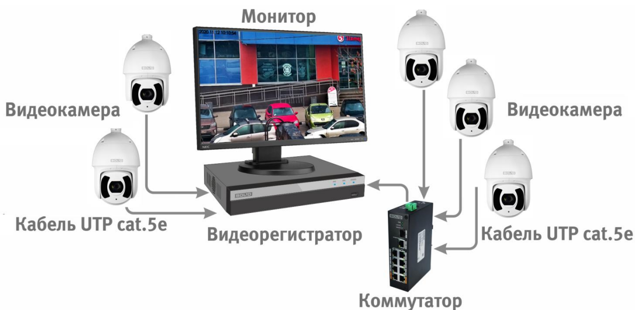
Рисунок 6.4 – Схема подключения видеокамеры к видеорегистратору
