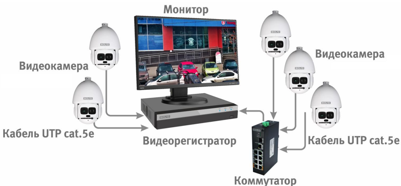
Рисунок 6.4 – Схема подключения видеокамеры к видеорегистратору
