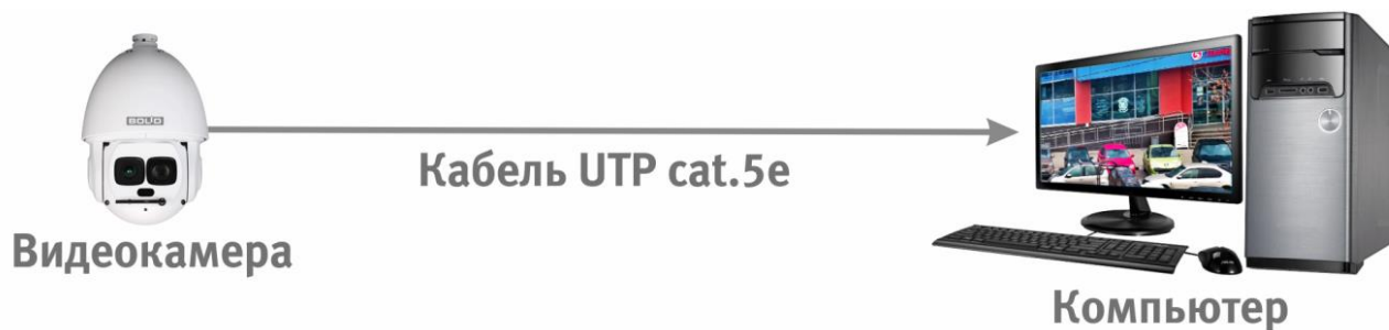
Рисунок 6.2 – Схема подключения видеокамеры к компьютеру
