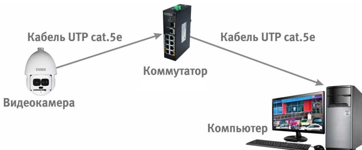
Рисунок 6.3 – Схема подключения видеокамеры к компьютеру через коммутатор
