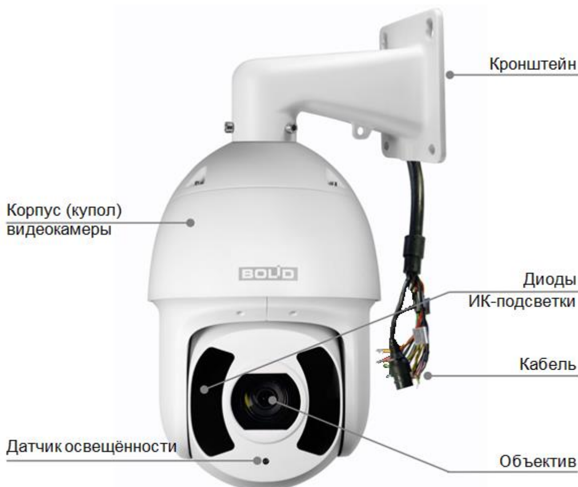
Рисунок 4.1 – Внешний вид и основные элементы видеокамеры
