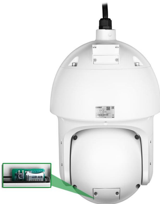
Рисунок 4.2 – Расположение слота для карты памяти и кнопки аппаратного сброса
