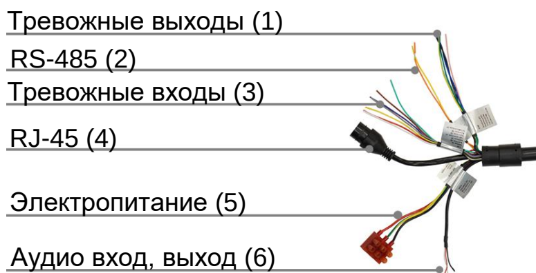
Рисунок 6.1 – Группы концевой раскладки кабеля видеокамеры
