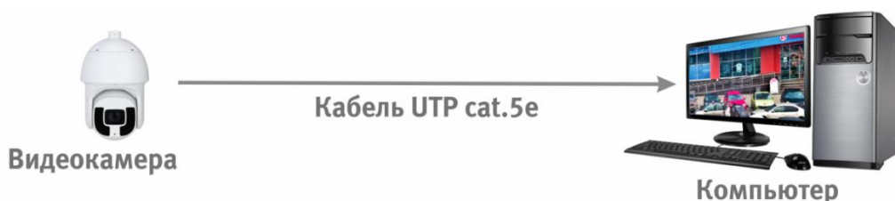
Рисунок 6.2 – Схема подключения видеокамеры к компьютеру
