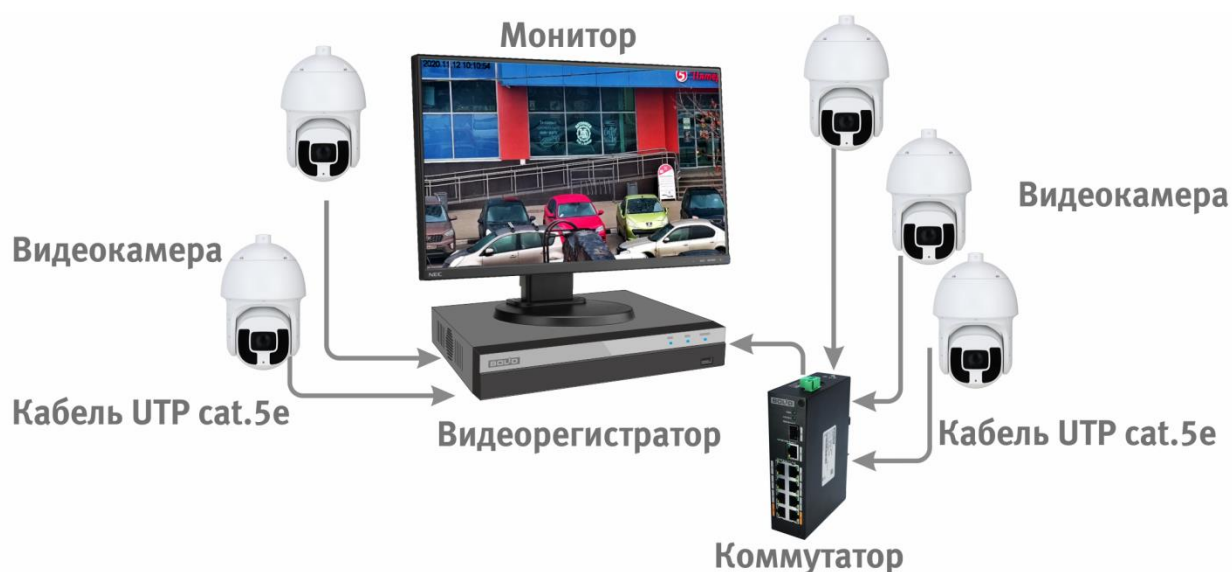
Рисунок 6.4 – Схема подключения видеокамеры к видеорегистратору
