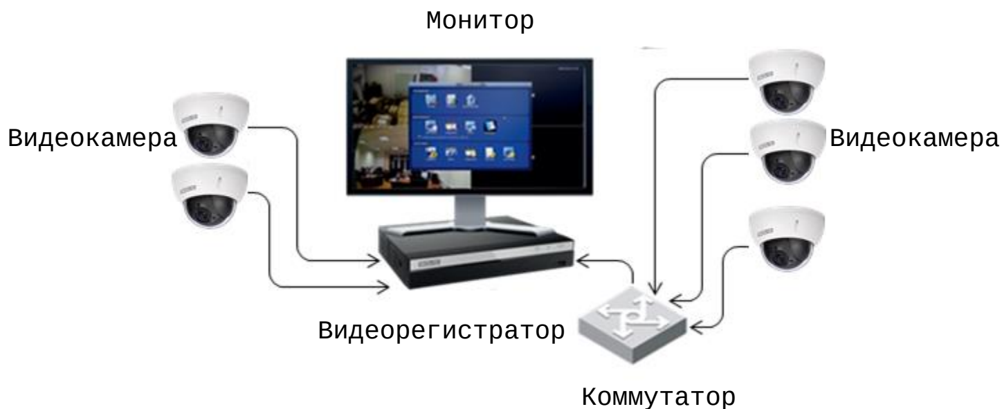
Рисунок 6.4 – Схема подключения видеокамеры к видеорегистратору
