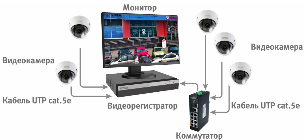
Рисунок 6.4 – Схема подключения видеокамеры к видеорегистратору
