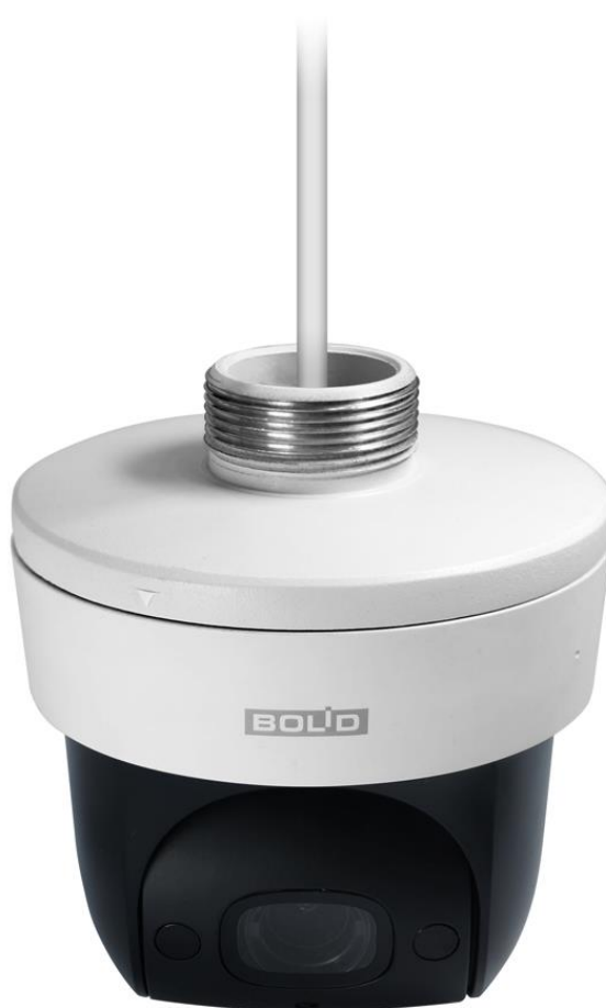
Рисунок 5.5 - Крепление монтажного адаптера к видеокамере
