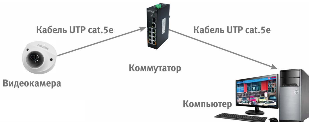
Рисунок 6.3 — Схема подключения видеокамеры к компьютеру через коммутатор
