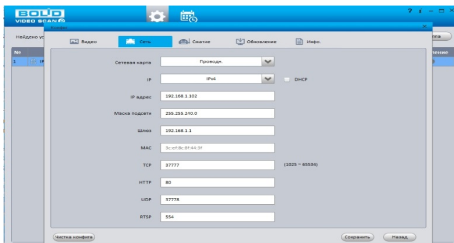
Рисунок 12.2 — Изменение IP-адреса видеокамеры с помощью утилиты «BOLID VideoScan»
