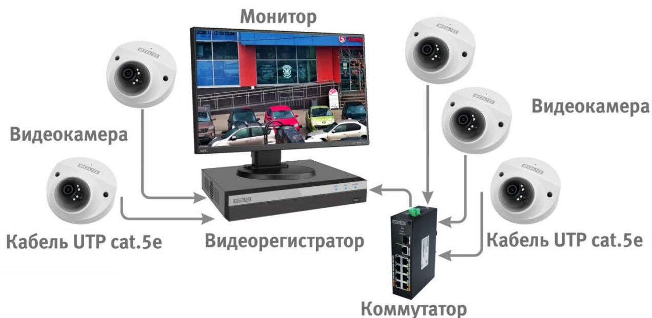
Рисунок 6.4 — Схема подключения видеокамеры к видеорегистратору
