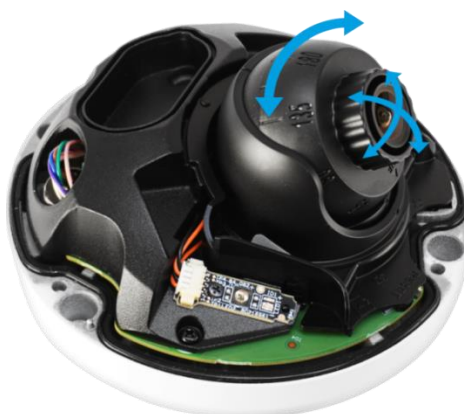
Рисунок 5.8 – Настройка направления объектива
