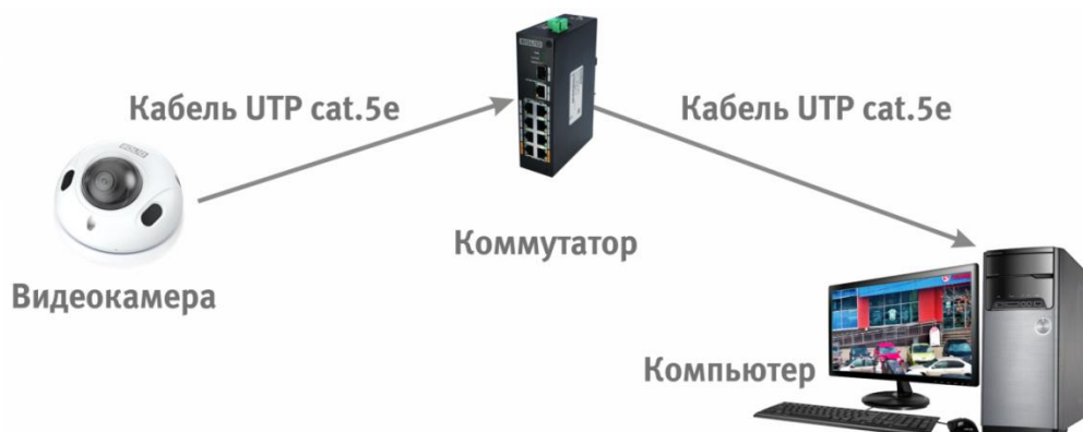
Рисунок 6.3 – Схема подключения видеокамеры к компьютеру через коммутатор
