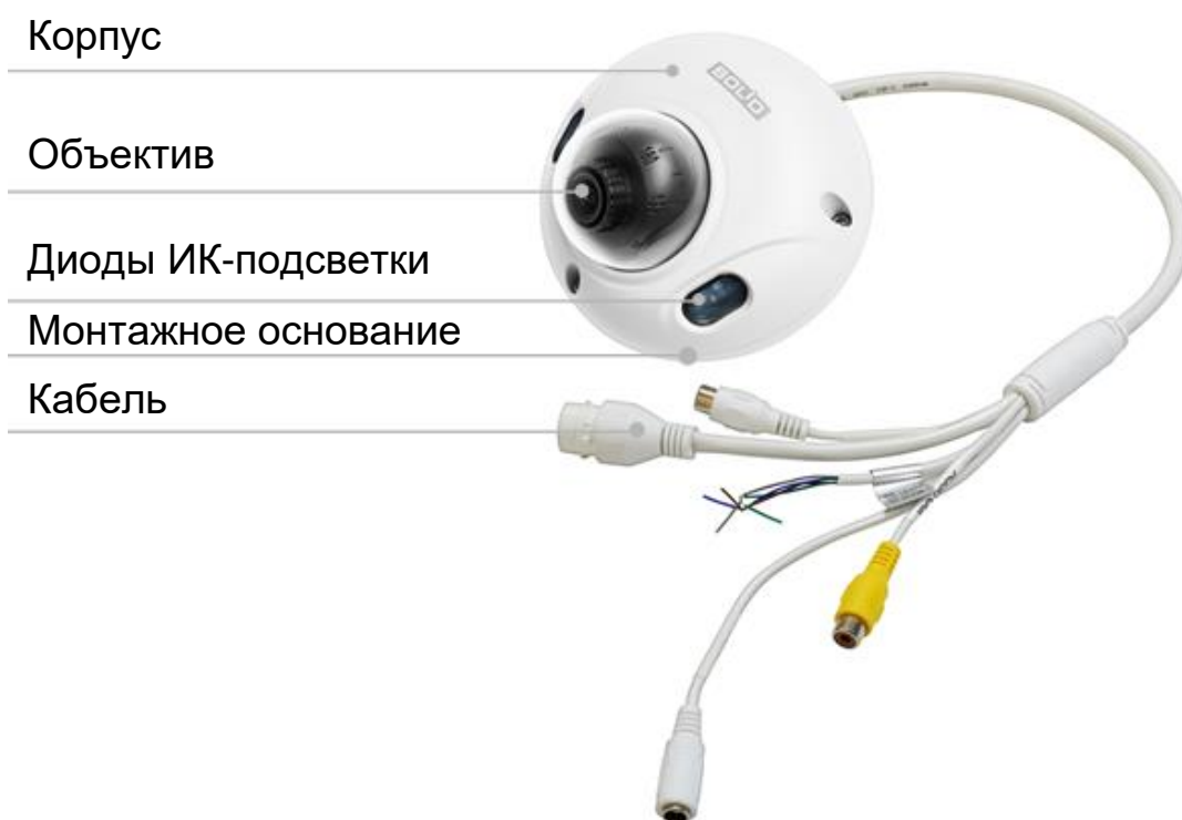
Рисунок 4.1 – Внешний вид и основные элементы видеокамеры
