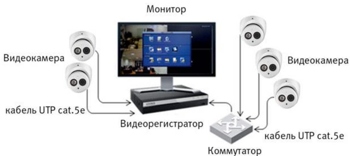
Рисунок 6.4 – Схема подключения видеокамеры к видеорегистратору
