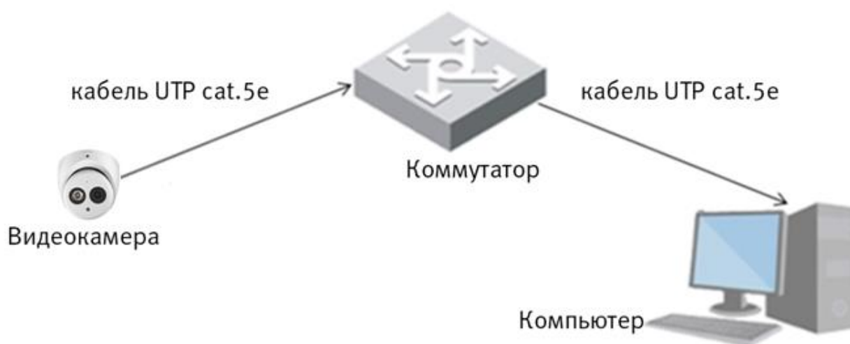
Рисунок 6.3 - Схема подключения видеокамеры к компьютеру через коммутатор
