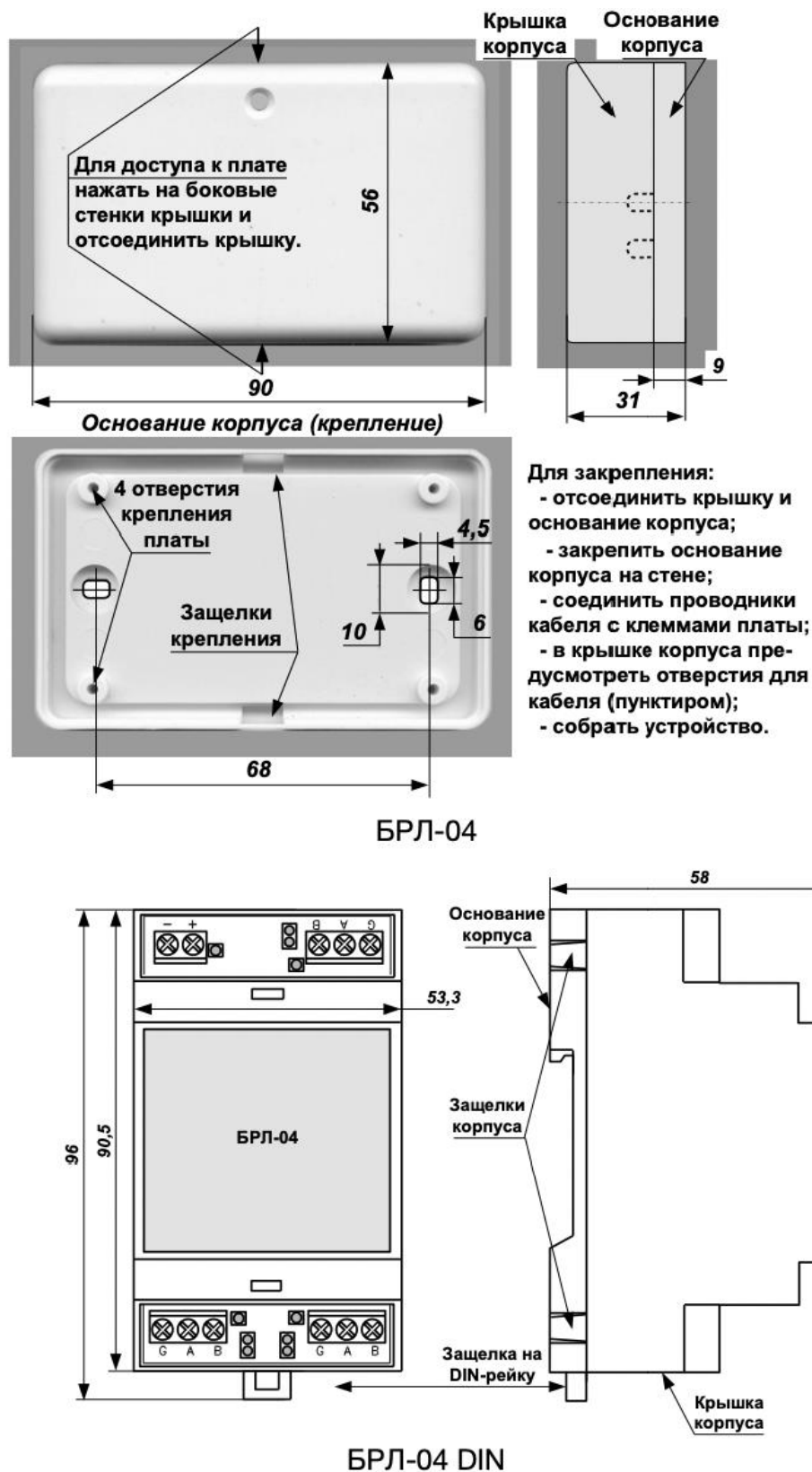
Рис. 5 Конструкция. Габаритные и присоединительные размеры
