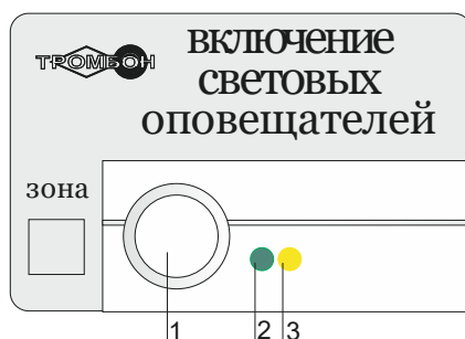
Рис. 3 Эскиз удалённого выключателя светового оповещения «Тромбон БСО»
