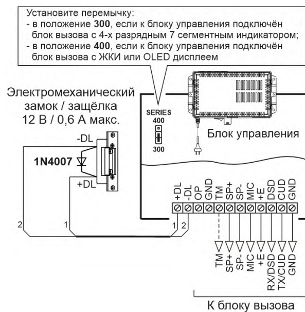
Рисунок 11.4 – Схема соединений блока управления, блока вызова и электромеханического замка / защёлки
