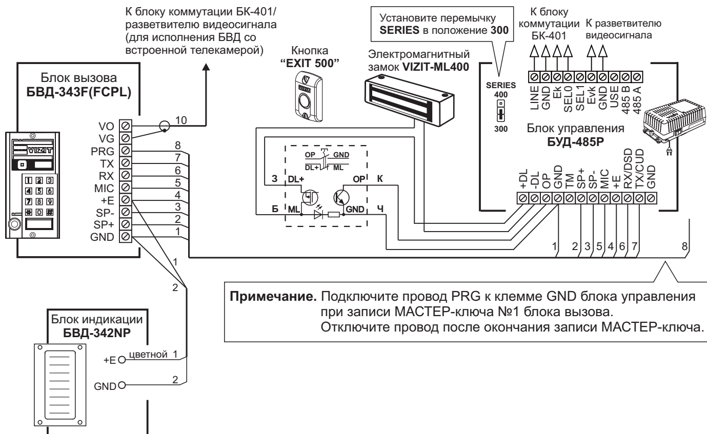
Рисунок 2 - Схема соединений блока вызова БВД-343F(FCPL) с блоком управления БУД-485Р , блоком индикации БВД-342NP , электромагнитным замком VIZIT-ML400 и кнопкой "EXIT 500"
