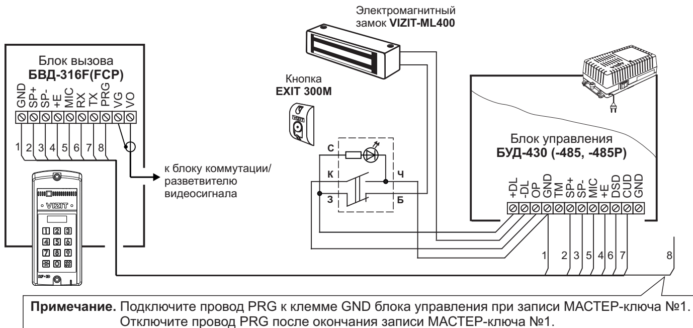
Рисунок 9 - Схема соединений блока вызова БВД-316F(FCP) с блоком управления БУД-430 (-485, -485P) , электромагнитным замком VIZIT-ML400 и кнопкой EXIT 300M
