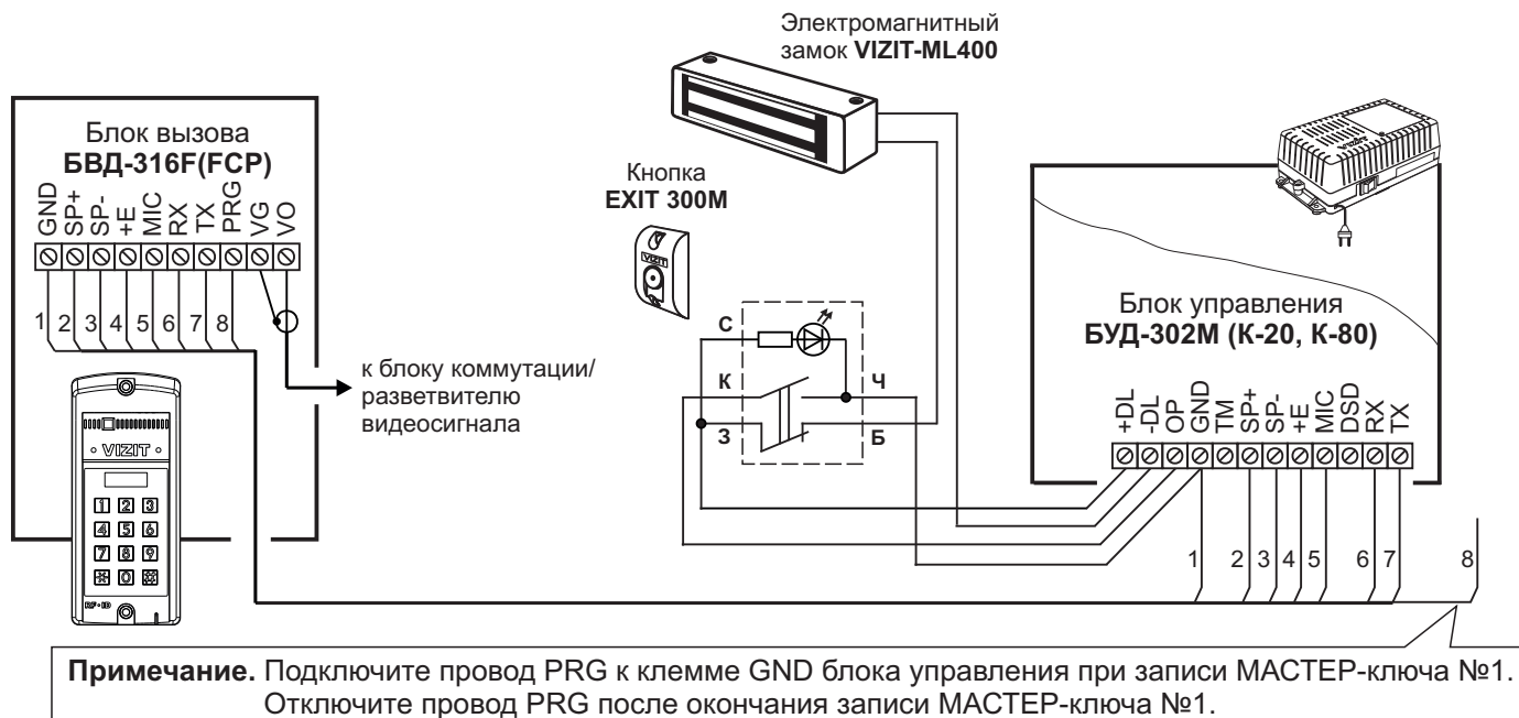
Рисунок 6 - Схема соединений блока вызова БВД-316F(FCP) с блоком управления БУД-302М (К-20, К-80) , электромагнитным замком VIZIT-ML400 и кнопкой EXIT 300М
