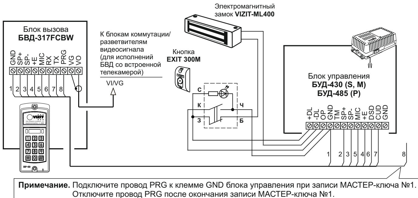
Рисунок 9 - Схема соединений блока вызова БВД-317FCBW с блоками управления БУД-430 (S, М), БУД-485 (Р) , электромагнитным замком VIZIT-ML400 и кнопкой EXIT 300M
