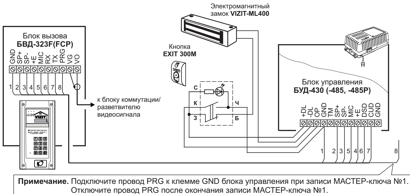
Рисунок 10 - Схема соединений блока вызова БВД-323F(FCP) с блоком управления БУД-430 (-485, -485P) , электромагнитным замком VIZIT-ML400 и кнопкой EXIT 300M
