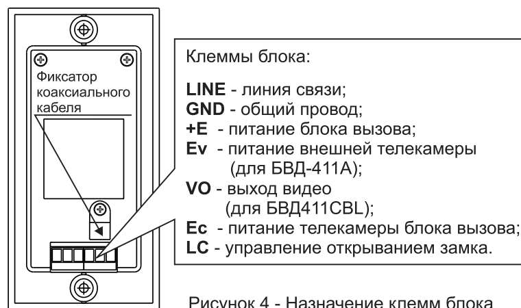
Рисунок 4 - Назначение клемм блока
