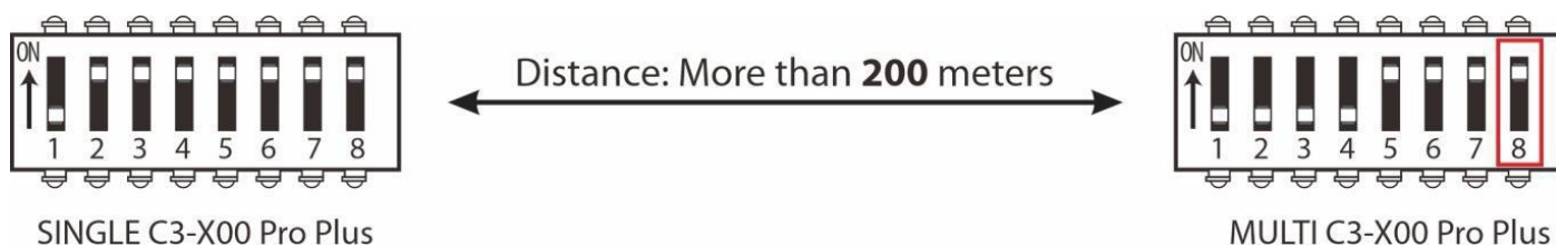
Рисунок 5-5. Положение переключателя для подключения терминатора
