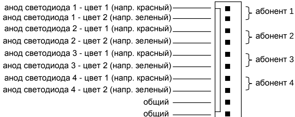
Рисунок 3. Способ подключения светодиодов к контактам гнезда J1 панели индикации при совместной работе со станцией мониторинга STAM-1.
