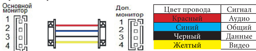
Расширенная схема подключения
