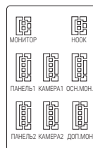
Разъемы подключения внешних устройств
