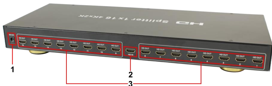
Рис.3 HDMI разветвитель D-Hi1161, разъемы и индикаторы на задней панели
