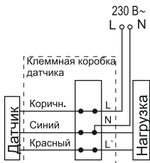
Рисунок 6 – Схема подключения датчиков ДД 024 и ДД 024В
