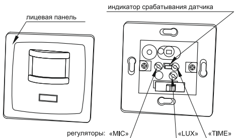
Рисунок 16 – Конструкция датчика движения ДД 035
