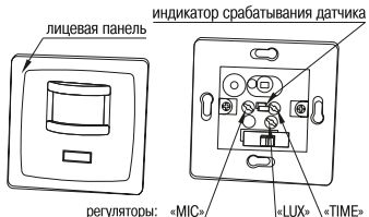
Рисунок 15 – Конструкция датчика движения ДД-035
