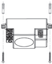
Рис. 8 - Монтаж датчика MW-706
