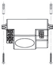
Рис. 8 - Монтаж датчика MW-706
