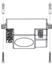
Рис. 8 - Монтаж датчика MW-706
