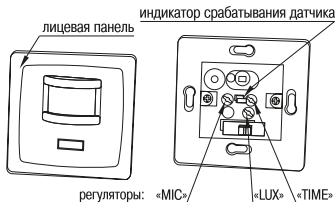
Рисунок 15 – Конструкция датчика движения ДД-035
